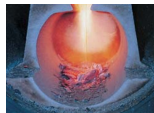
Hoření plamene v keramické spalovací tvarovce
